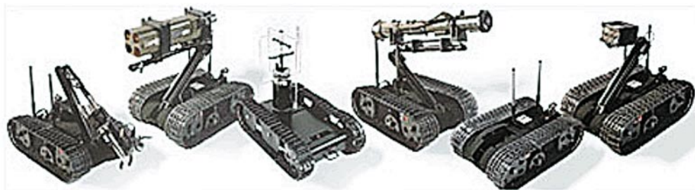
圖一 美國Foster-Miller公司以TALON機器人平臺為基礎，延伸發展出的軍用機器人系列照
