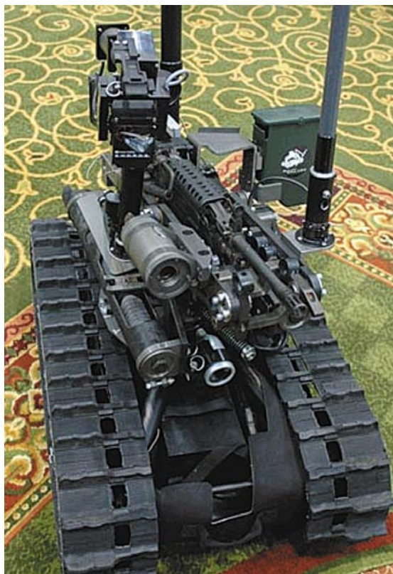
圖三 美國陸軍在伊拉克戰場上使用的SWORDS機器人，左圖為其正面照，右為細部說明
