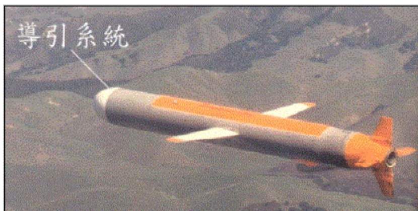
ALT：圖5 巡弋飛彈導引系統示意圖〔註八〕
