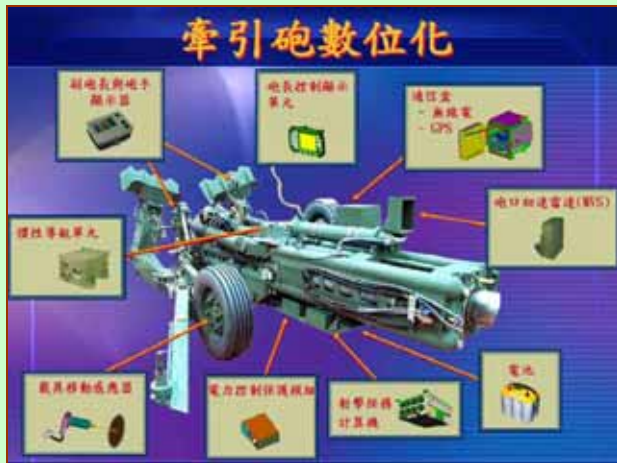
圖 31、美國準備裝配在 M777 火砲上的先進牽引砲數位化射控系統
