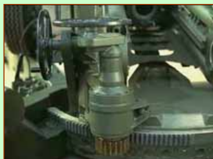
圖 19、方向機—手輪、傳動齒輪及環座齒輪
