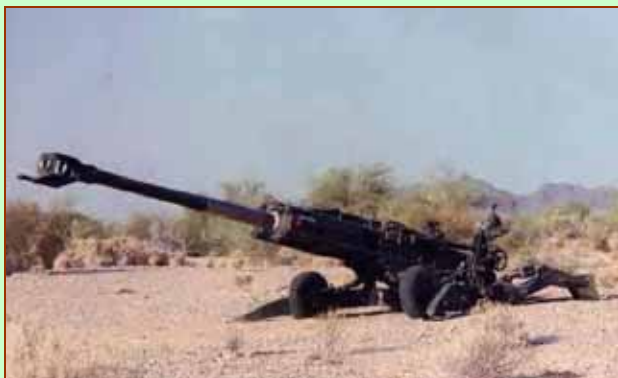
圖 21、穩定支架於火炮放列時，可確保因砲身前移帶來的火炮靜態穩定性和複進穩定性
