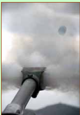
圖 5、射擊瞬間砲口制退器作用情形
