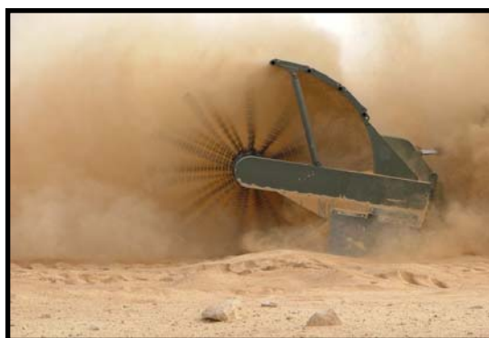
圖23 Armtrac-100掃雷車排雷鏈掃雷情形
