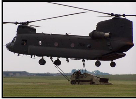
圖10 MV-4排雷車實施直昇機吊掛空中運輸 (資料來源： http://www.army-technology.com/contractors/indexAtoZ.html )
