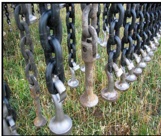
圖31 Scanjack-3500排雷車排雷鏈末端金屬鎚形物
