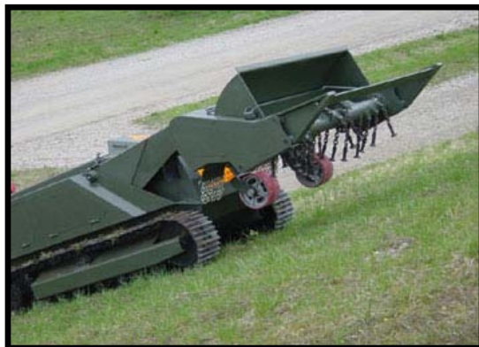
圖 12 MV-4 排雷車爬坡測試 (資料來源： http://www.dok-ing.hr/mv4 )
