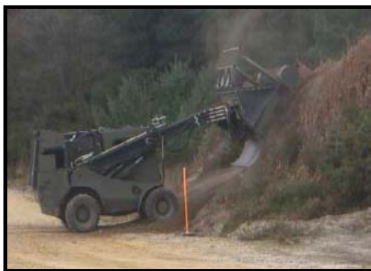
圖 3 Armtrac-75 排雷車套筒式伸縮吊桿
