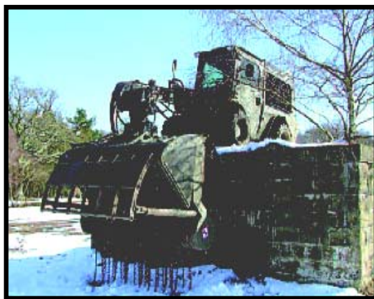
圖 4 Armtrac-75 排雷車具有能力移動旋轉排雷鏈
