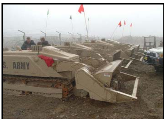
圖 13 美軍於波灣戰役中使用 MV-4 排雷車 (資料來源： http://www.dok-ing.hr/mv4 )
