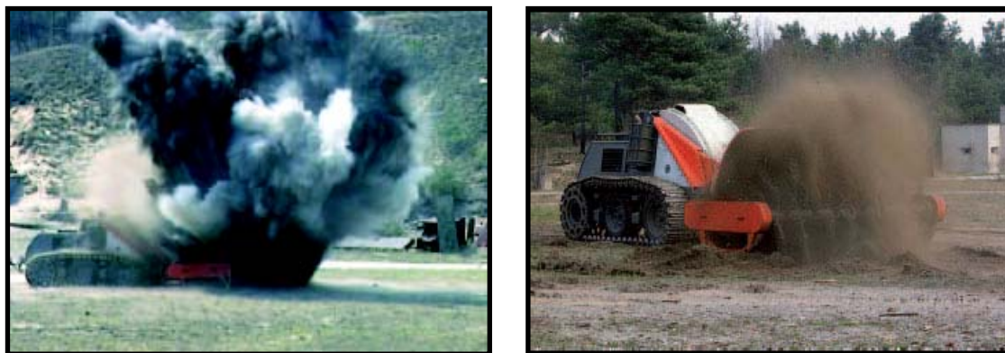
圖20 B5排雷車在雷區掃雷及清除AT戰防雷引爆 (資料來源：Mechanical Demining Equipment Catalogue 2006- GICHD)
