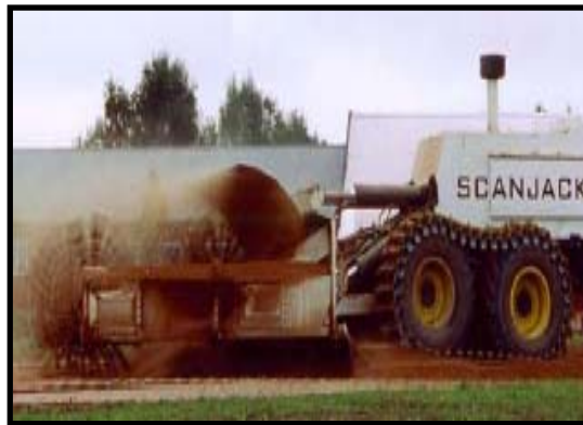
圖30 Scanjack-3500掃雷車前置雙排雷鏈系統 (資料來源： http://www.scanjack.com/pdf/scanjack-brochure.pdf )
