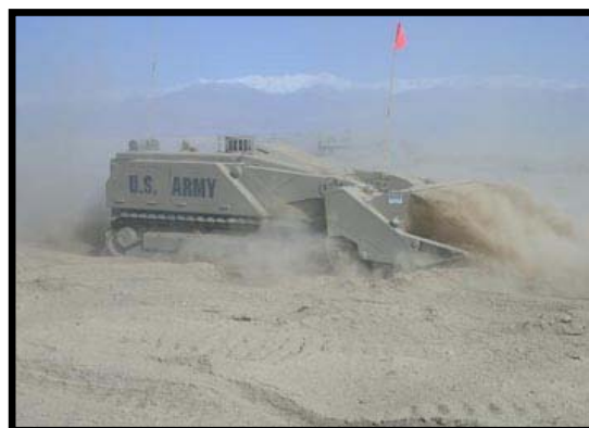
圖 13 美軍於波灣戰役中使用 MV-4 排雷車 (資料來源： http://www.dok-ing.hr/mv4 )
