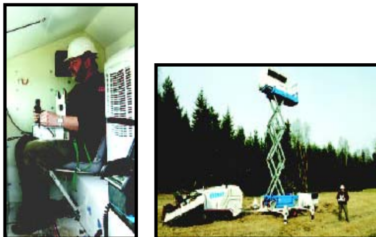
圖14 操作人員在裝甲防護作業艙實施遙控MineCat-140排雷車掃雷作業 (資料來源：Mechanical Demining Equipment Catalogue 2006- GICHD)
