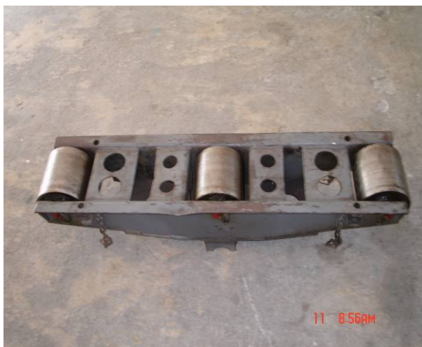
圖三側邊導輪損壞之大滾具
