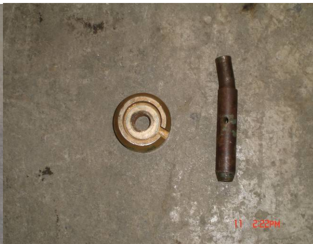
圖四大滾具導輪及軸心損壞情形
