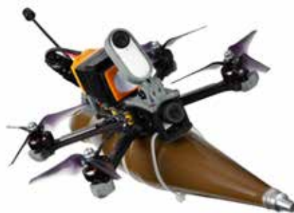
圖2 FPV無人機攜帶反戰車砲彈
