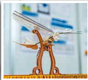
▲利用拍撲動力和飛行控制律，研發仿生型智能滯空飛行無人機；以及運用量子技術，研製石墨烯約瑟夫森接面晶片，彰顯科技創新成果。
