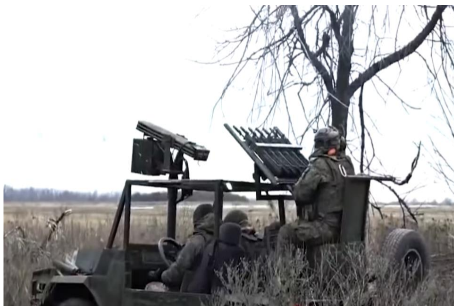
圖八：俄軍展示配備 6 支突擊步槍的反無人機越野車 資料來源： https://www.youtube.com/watch?v=CUCP8UBgYMI
