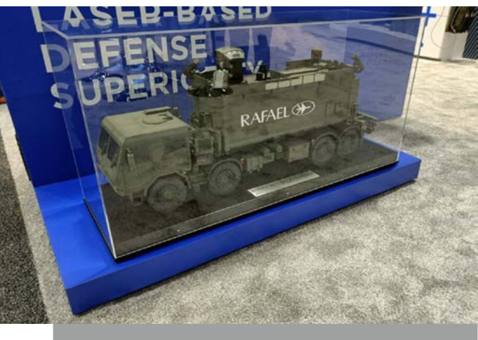
2024年美國陸軍協會（AUSA）展出的鐵束-M模型。可見後部模組頂部設有光束導向器及四具固定式DRS RADA nMHR雷達。（Source: Mark Cazalet）
