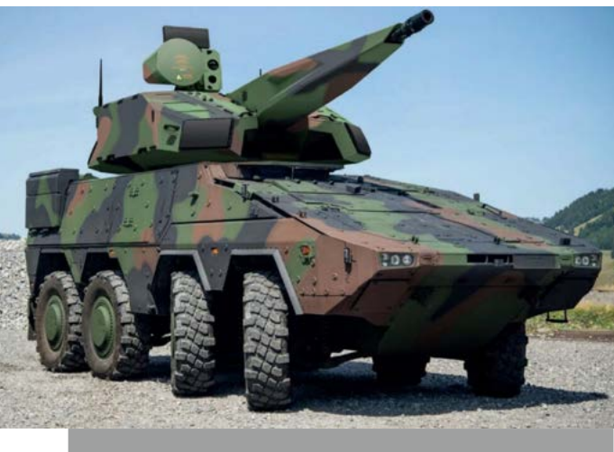
天空突擊兵35捨棄刺針等飛彈，改為僅配備機砲的方案，使用與半機動式Skynex系統相同的KDG 35公厘機砲。
