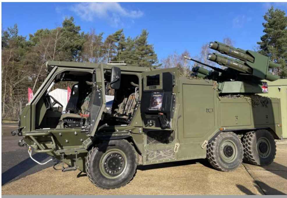
搭載Moog RIwP砲塔的Supacat HMT，配備30公厘機砲、星光及硫磺石等彈藥。（Source: Supacat）
