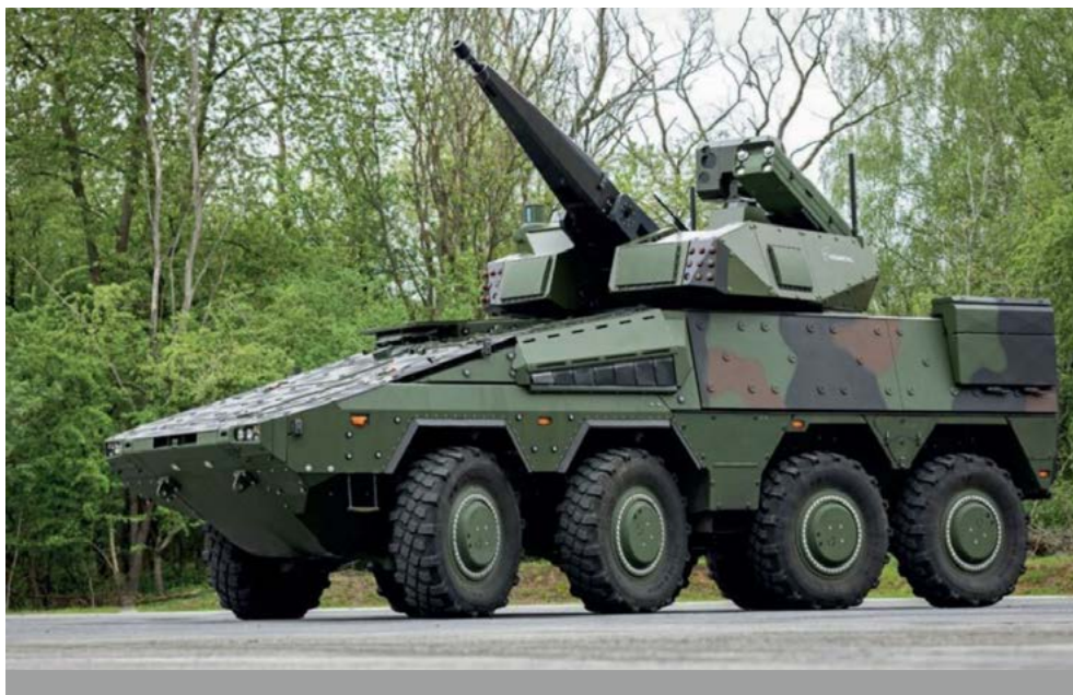
天空突擊兵30提供一種無人化的獨立解決方案，使操作人員位於載具平臺內的砲塔下方。
