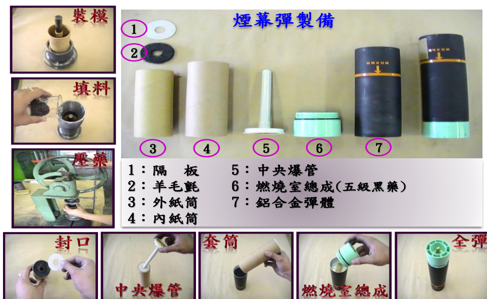
圖 4 煙幕彈製備材料與製程
