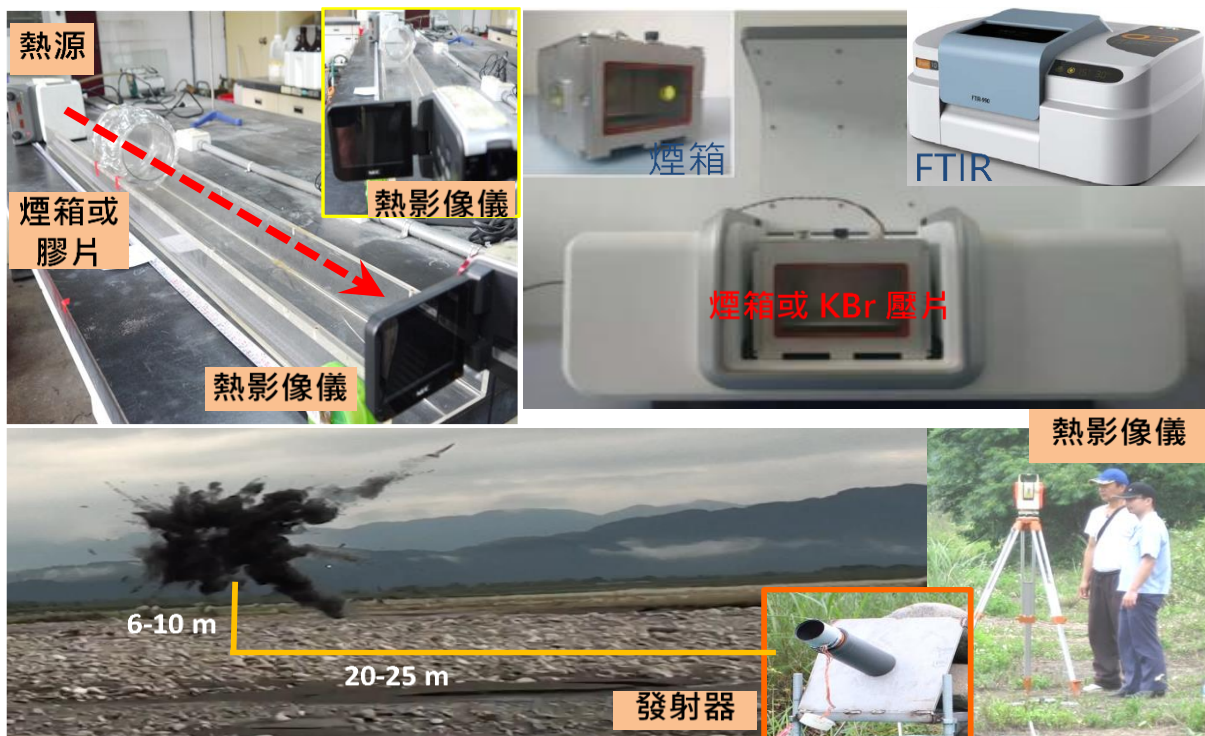
圖 2 使用壓片法、煙箱試驗法和野外試驗法測試紅外光遮蔽效能
