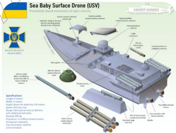
圖 7 烏克蘭「海上寶貝(Sea Baby)」可裝載各式攻擊炸藥，適合打擊靜態目標
