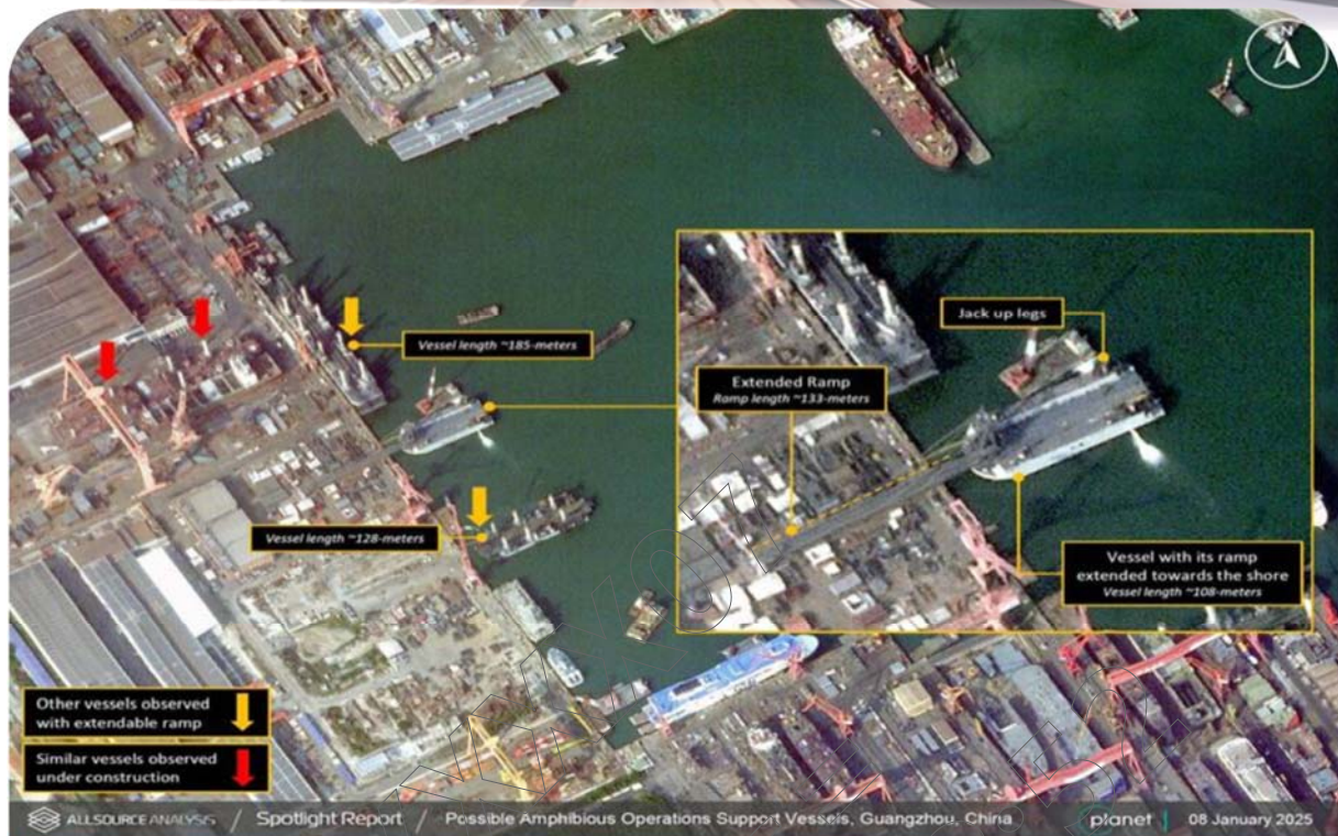
圖8 駁船有4個、6個與8個巨型升降支柱
