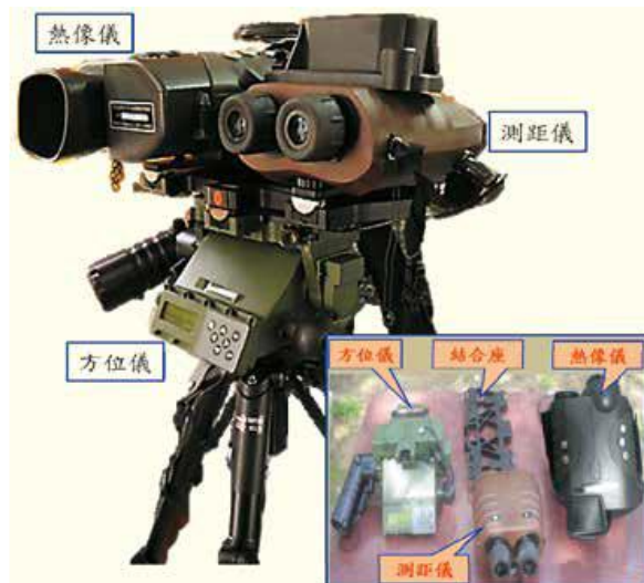
圖 1 TS102A1 式多功能雷觀機外觀及諸元
