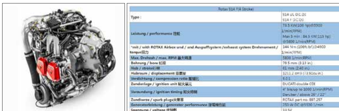
圖4 翼龍2無人機ROTAX914UL發動機
