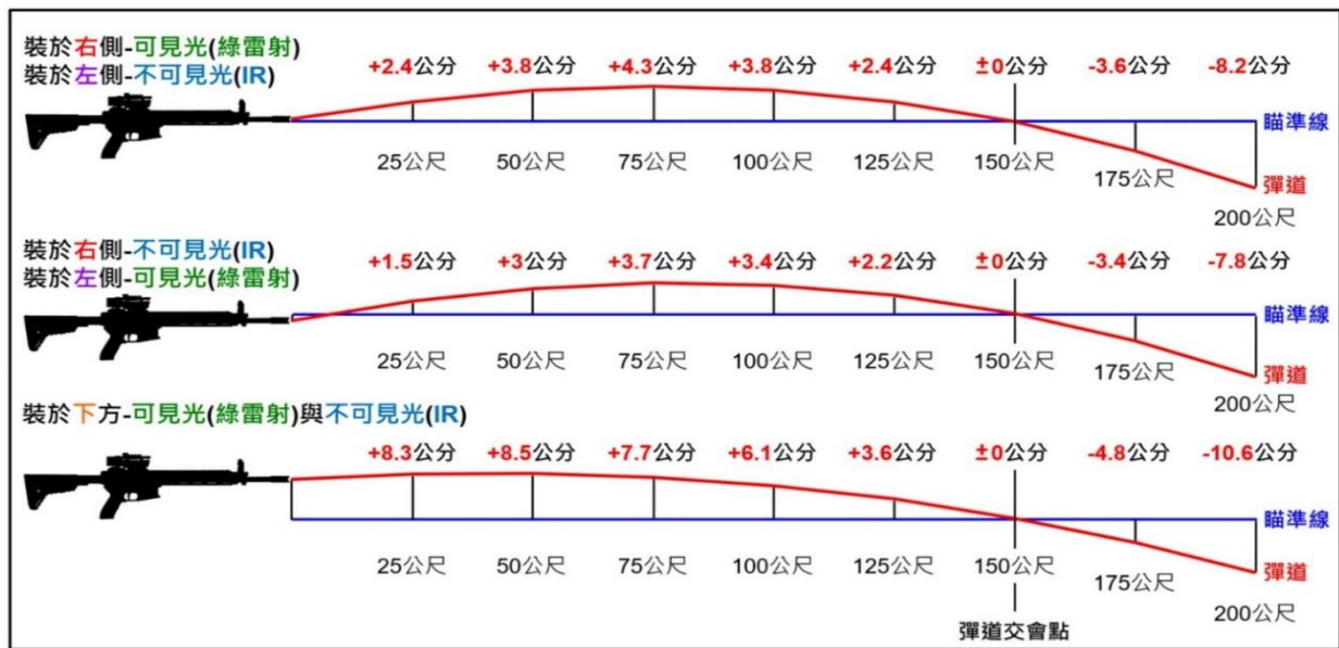
圖六 T112 步槍搭配三合一雷射器安裝於不同方向 200 公尺內彈道圖 資料來源：作者自行調製（2025 年 3 月 16 日）
