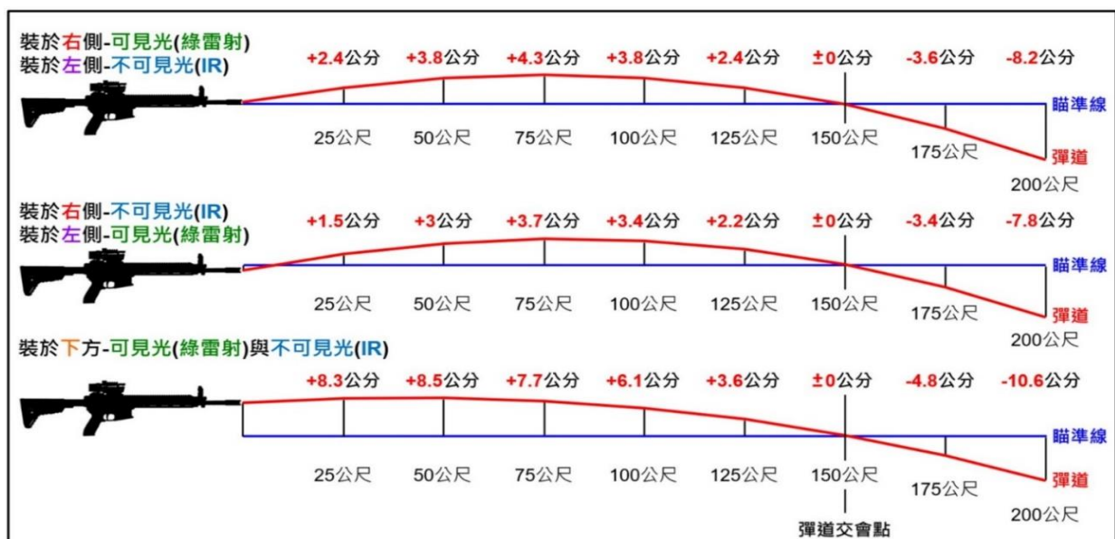
圖六 T112 步槍搭配三合一雷射器安裝於不同方向 200 公尺內彈道圖
