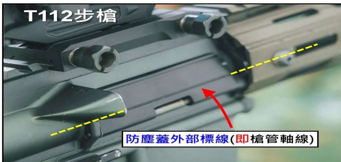
圖九 T112 步槍—槍管軸線測量位置 資料來源：作者自行調製（2025 年 3 月 16 日）
