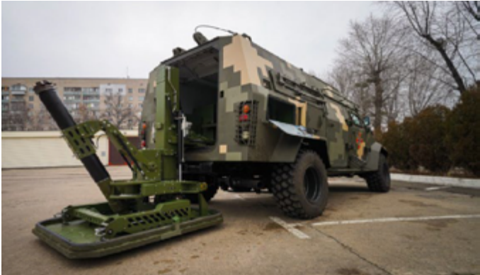
圖10 BARS-8MMK 120mm車載迫擊砲系統
