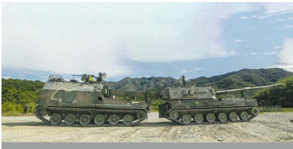
K10彈藥再補給車透過自動輸送帶，為K9雷霆自走榴彈砲補充155公厘火炮彈藥。美陸軍的M992野戰砲兵支援車已不再使用此功能。(Source: Hanwha)
