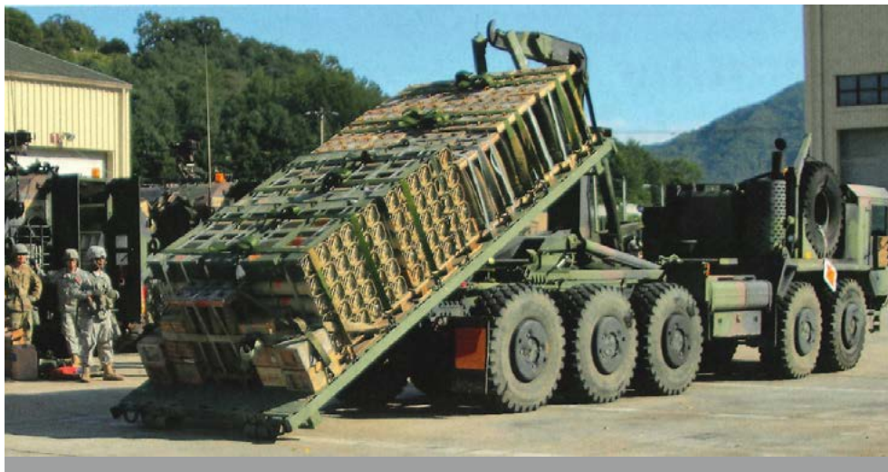
奧希科什M1075臺板裝載系統正在卸載彈藥，供南韓哈維營區 (Camp Hovey)駐韓美陸軍的第82野戰砲兵團第1營A連使用。圖為官兵裝載M109A6帕拉丁自走榴彈砲與M992野戰砲兵支援車(Field Artillery Support Vehicles, FASV)火箭彈藥。(Source: US DoD)
