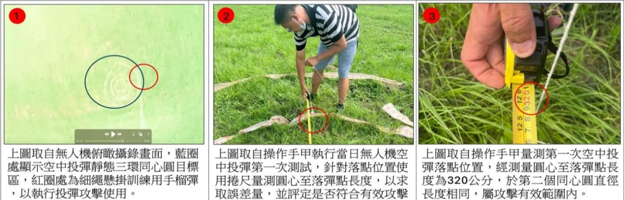
商用無人機空中投彈對靜態目標攻擊測試結果示意圖(第一次測試)
