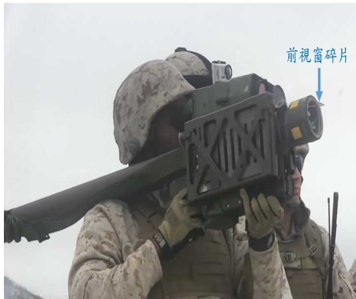
圖 5 飛彈發射後前視窗碎片
