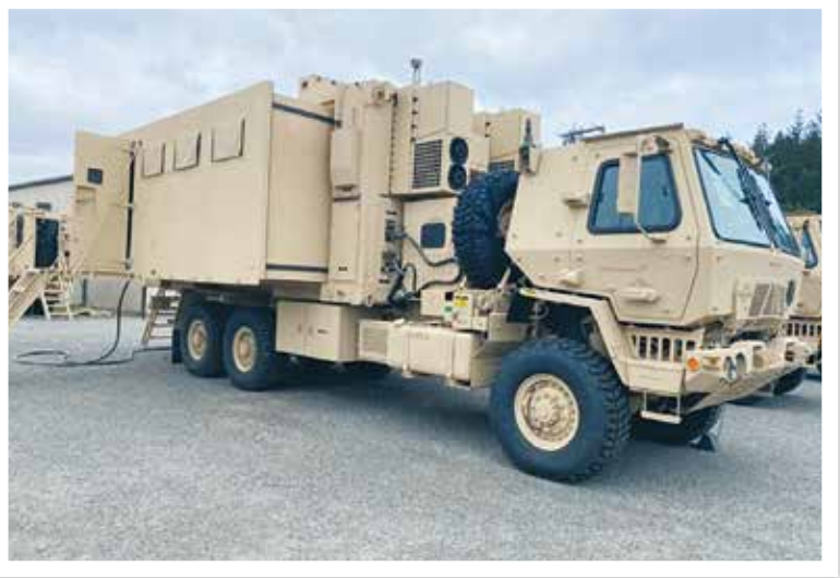
圖6 設置於M1087 可展開式箱型車的指揮所整合基礎設施系統(Command Post Integrated Infrastructure System, CPI2)
