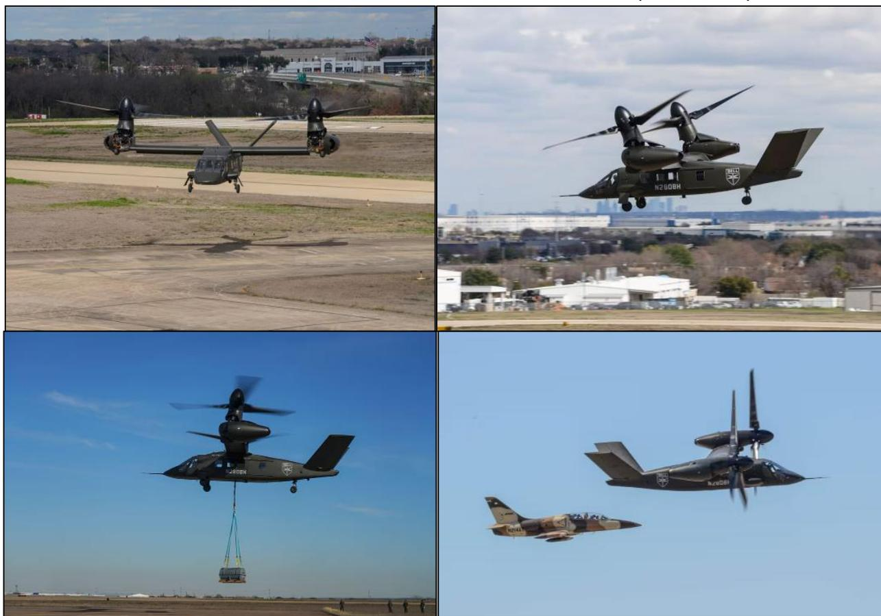
圖十二 V-280 傾斜旋翼機垂直起降、空中懸停、吊掛運輸及高速飛行
