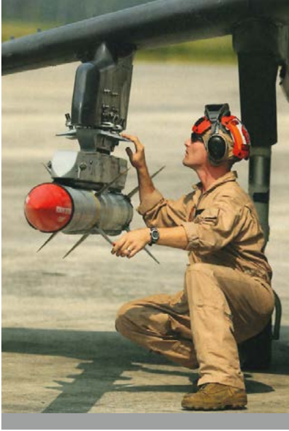
美陸戰隊第223攻擊中隊(Marine Attack Squadron 223, VMA-223)人員完成AV-8B獵鷹(Harrier)戰鬥機掛載AIM-129A先進中程空對空飛彈的檢查作業。儘管該中隊主要執行對地攻擊任務，但其飛行員也接受訓練，以使用雷達導引飛彈進行視距外空戰。
