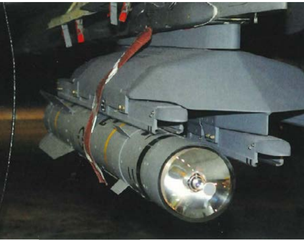
裝載於龍捲風(Tornado)GR4戰轟機上的硫磺飛彈。該武器可低空飛行以避免被偵測，並可預先設定搜尋範圍，僅在特定目標區域啟動搜尋，以降低對友軍部隊的風險。(Source: UK MoD)
