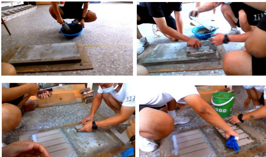
圖 3-5 測試用磁磚牆面製作
