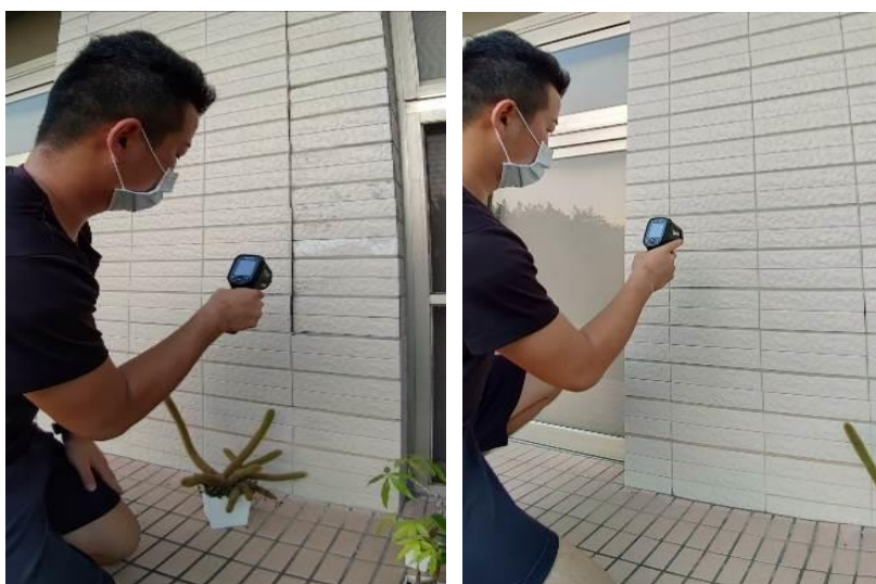
圖 3-3 確立紅外線熱顯像儀顯影情況
