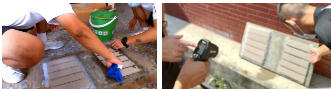
圖 2-3 牆面樣本之製作(左)與陽光曝曬測試(右)
