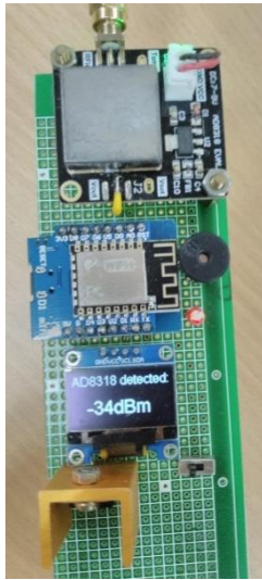
圖三十、(a)擺放在30度位置上的接收指示器的反應 (b)擺放在0度位置上的接收指示器的反應
