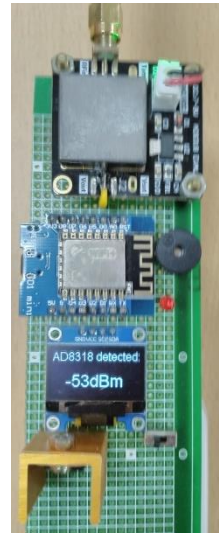
圖三十、(a)擺放在30度位置上的接收指示器的反應 (b)擺放在0度位置上的接收指示器的反應
