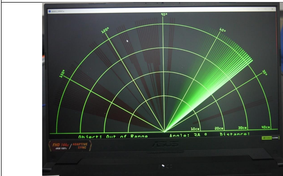
圖 34 超音波雷達物體掃描及模擬顯示 2
