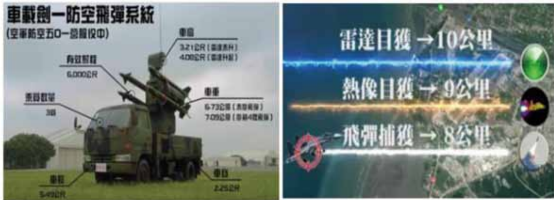
圖3. 車載劍一防空飛彈系統及接戰模式
