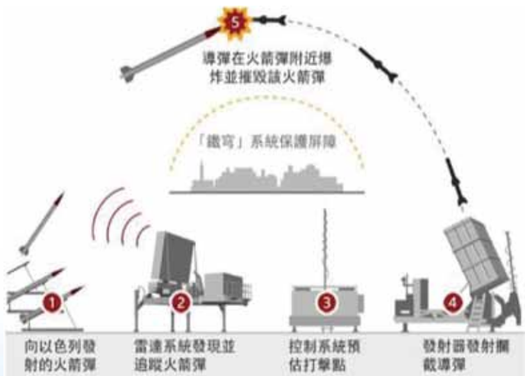
圖6. 鐵穹防禦系統運作程序圖
