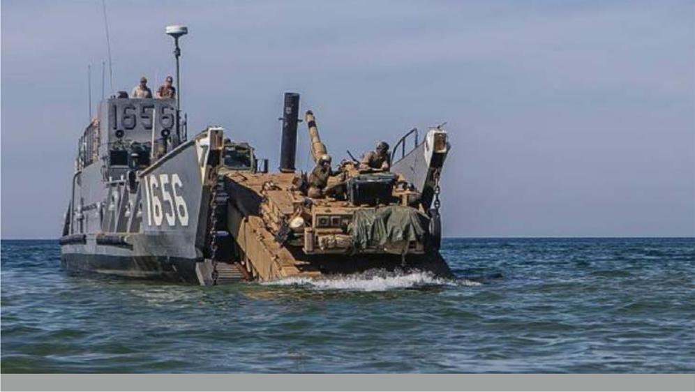
配備深水涉水套件的M1A1艾布蘭戰車可以涉水六英尺深。可惜的是，M1布克戰鬥車缺少這樣的套件。(Source: USMC/Dengrier M. Baez)
