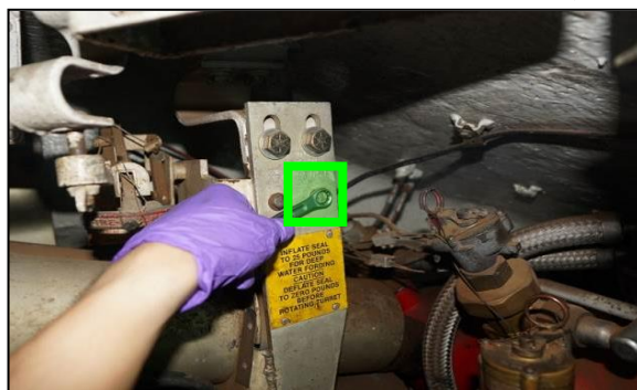
圖 68-結合外接制動油管
