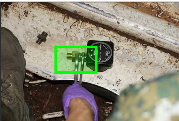
圖 73-三通管與外接油管結合
