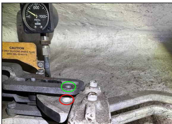
圖 46-螺釘接觸制動桿後將旋緊螺帽
