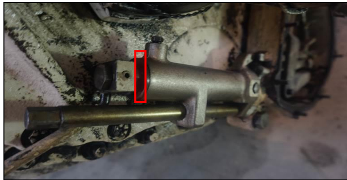
圖 38-輔助缸活塞襯墊未安裝
