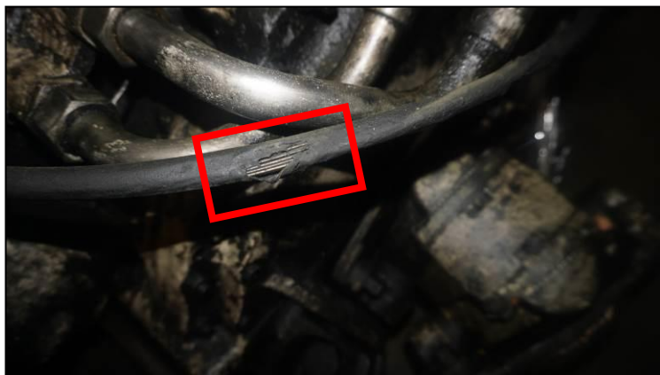
圖 36-變速箱制動索損壞
