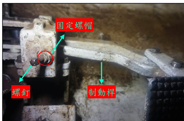
圖 46-螺釘接觸制動桿後將旋緊螺帽
