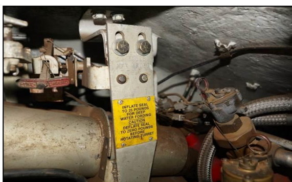
圖 65-裝上安裝托架
