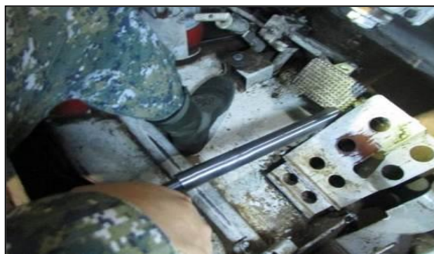
圖 89-放鬆制動踏板使上配件夾靠
