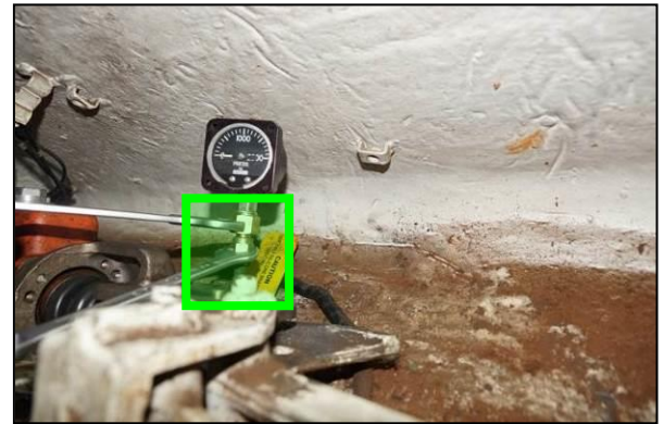
圖 74-將三通管與外接油管緊定
