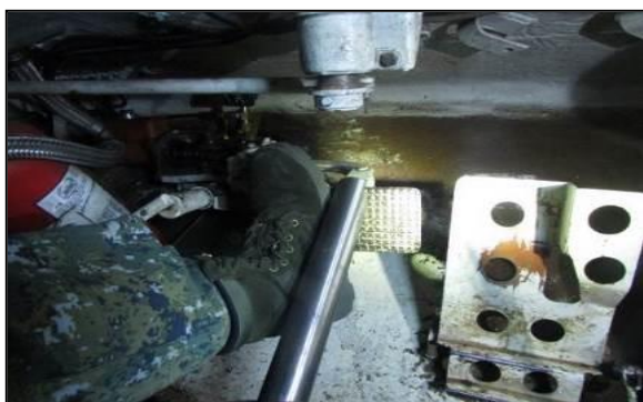
圖 88-踏下制動踏板使夾靠上配件
