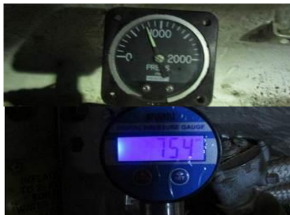
圖 91-使制動壓力超過前次鎖定壓力
