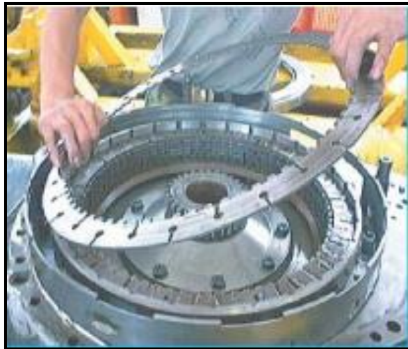
圖 27-多片濕式煞車制動帶
