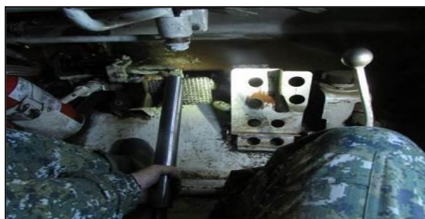
圖 89-放鬆制動踏板使上配件夾靠
