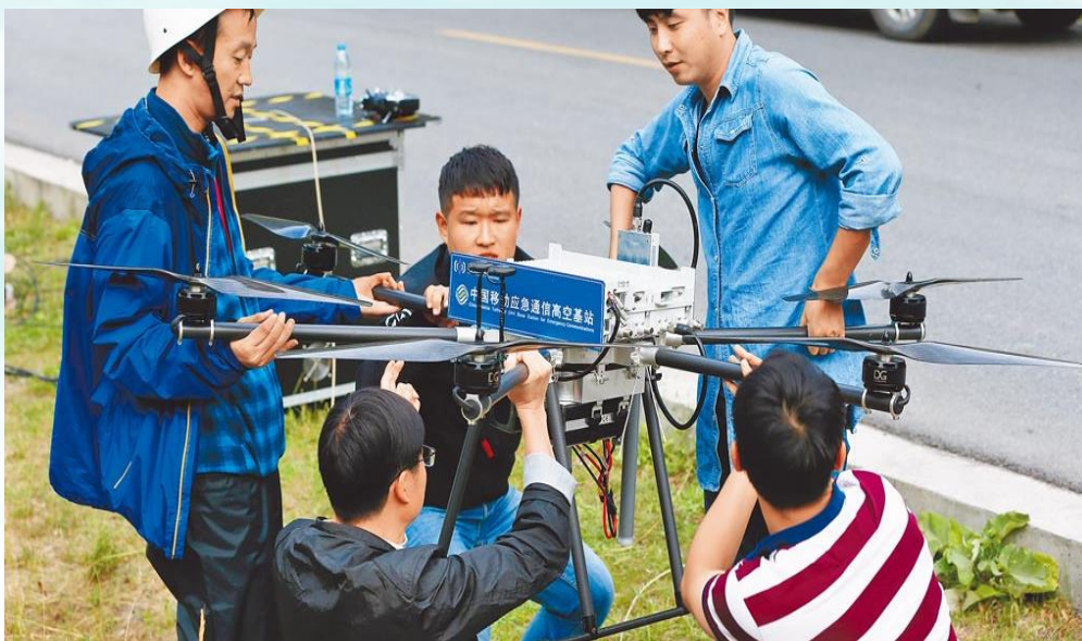
圖 8 繫留式無人機緊急通信高空基地臺
