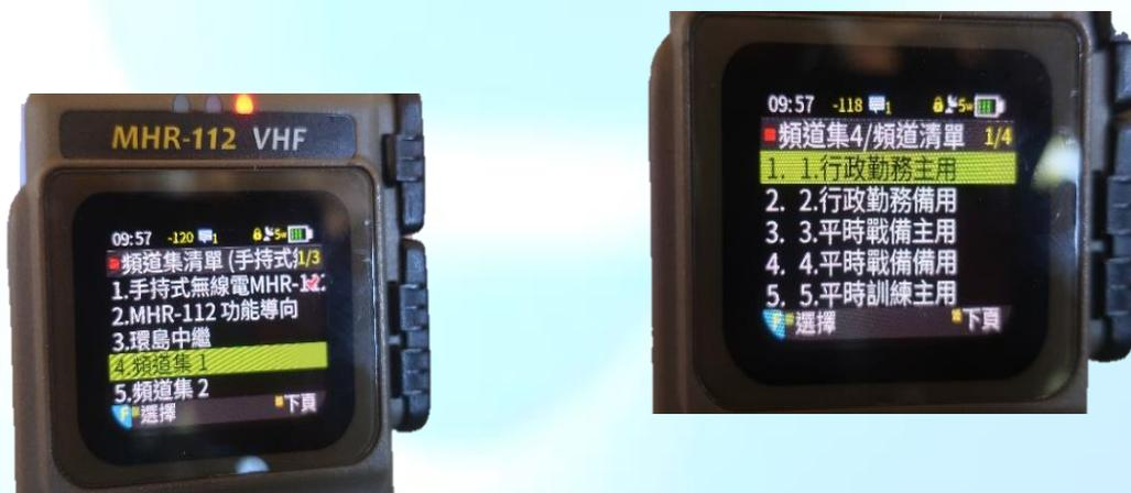
圖12 MHR-112手持無線電機頻率集示意圖
