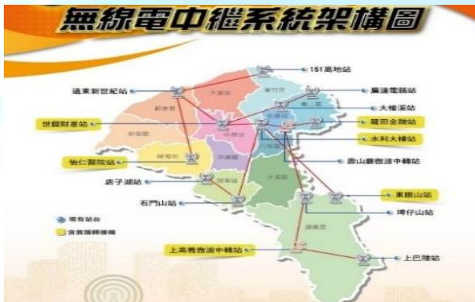
圖8 桃園無線電中繼系統示意圖
