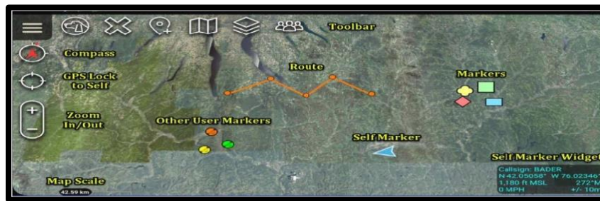
圖 1 ATAK 系統操作介面示意圖
