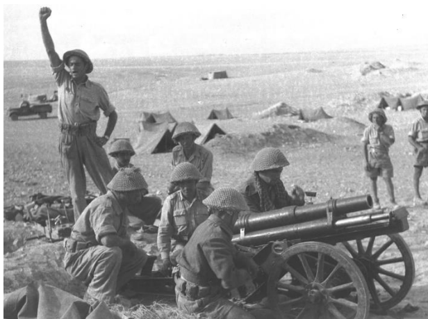
圖 9 施耐德(Schneider) M1906 65mm 山砲操作照片(射擊前砲管固定在後方)
