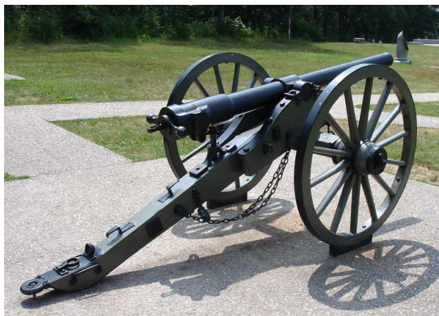
圖 3 惠特沃斯後膛裝填線膛砲（Whitworth rifled cannon breech-loading artillery）
