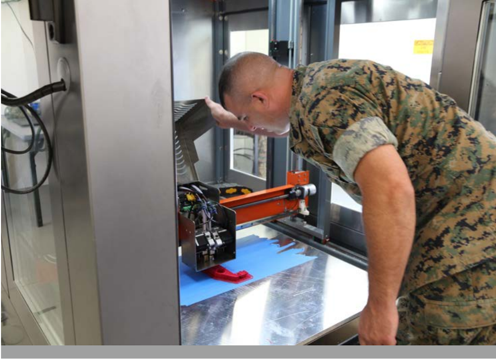
美陸戰隊在可移動式的遠征裝配實驗室(Expeditionary Fabrication Lab, X-FAB)中展示大型3D列印機，該設備可在前線製造維修與更換零件。(Source: DVIDS)
