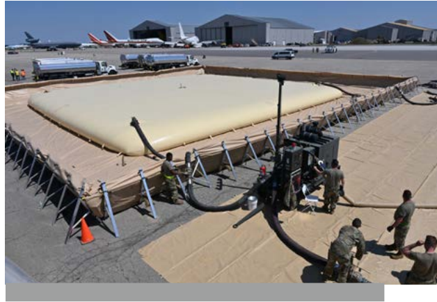
2021年5月18日，空軍人員在密西根州奧斯科達—沃特史密斯機場(Oscoda-Wurtsmith Airport)的機動守護者演習中，為一個21萬加侖的機動油囊加油。(Source: USAF/Aaron Irvin)
