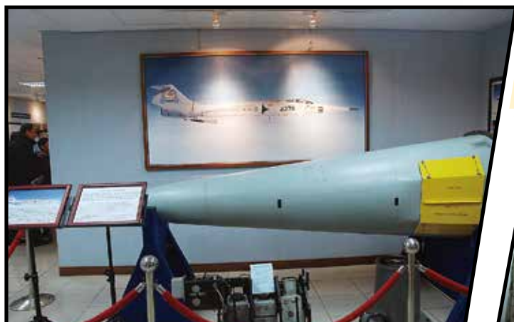
▲特別設計的加長型鼻錐以便裝置相機，黃色保護蓋內為鏡頭位置，飛行前需拆除【照片由作者提供】。
