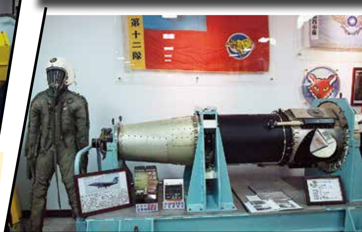
▼始安機所使用的PC-201 LOROP 72吋長距離掃描式照相機，作者攝於第十二隊隊史館【照片由作者提供】。
