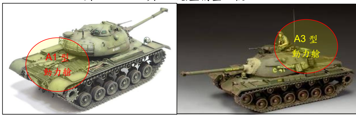
圖 2-M48A1 與 A3 底盤構型比較
