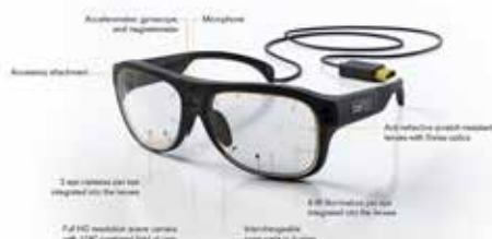
圖1 「Tobii Pro Glasses 3」可攜式眼鏡型眼球追蹤儀
