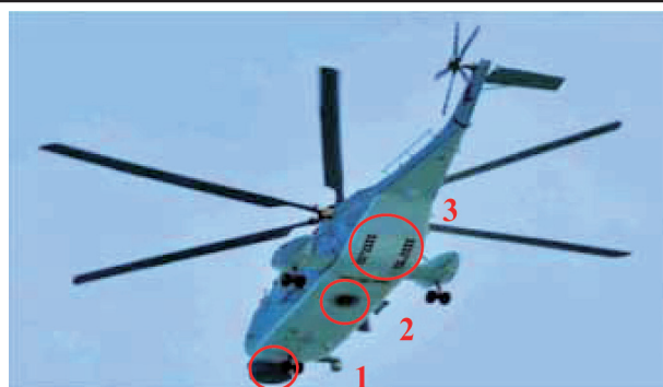
圖四：中共「直-18F」機腹依序為搜索雷達、吊放聲納及聲納浮標釋放手口
