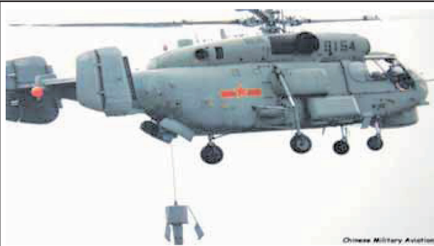
圖一：中共「卡-28」反潛機配備「VGS-3」吊放聲納
