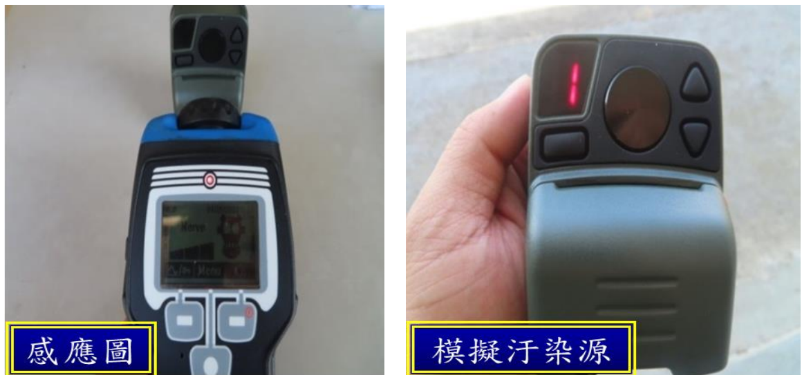
圖 13 超聲波模擬汙染源感應
