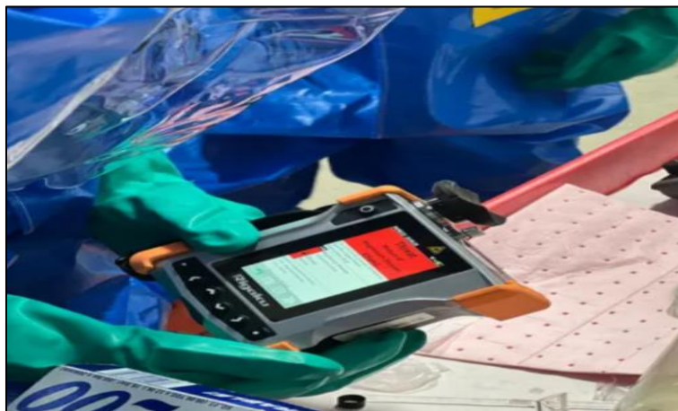
圖 2 ResQ CQL 1064 nm 拉曼分析儀操作示意圖
