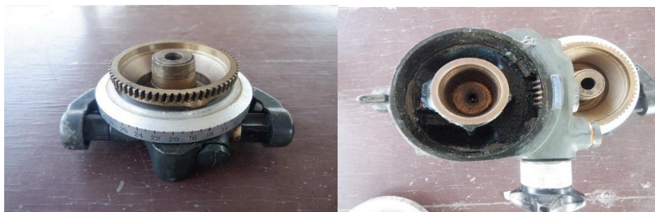
圖 18 M2 方向盤內部機械螺紋機構設計
