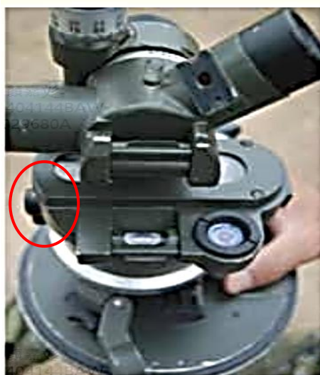
圖 4 M2 方向盤磁針解脫鉸示意圖
