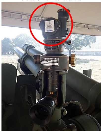
圖 19 火炮瞄準鏡黏貼反射雷射片
