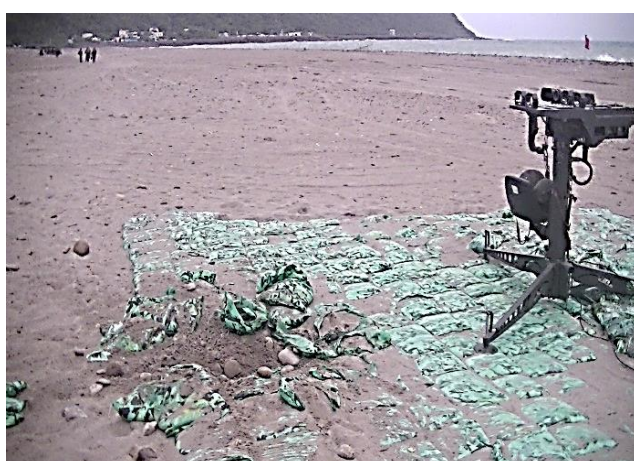
圖 8 沙包損壞情形
