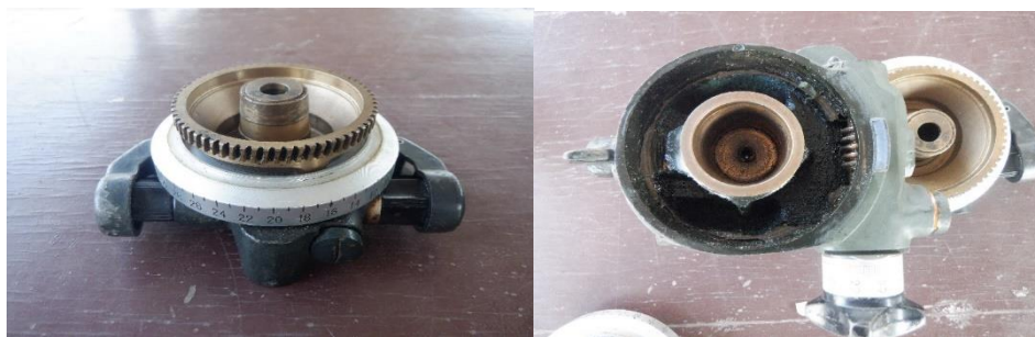
圖 18 M2 方向盤內部機械螺紋機構設計
