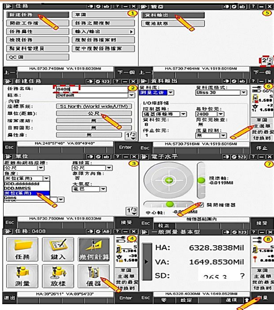
圖 17 測距經緯儀資料鏈結設定操作程序圖
