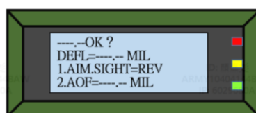
圖 14 CDU 手持控制器反覘方向角設定
