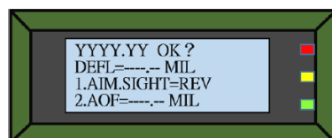
圖 14 CDU 手持控制器反覘方向角設定
