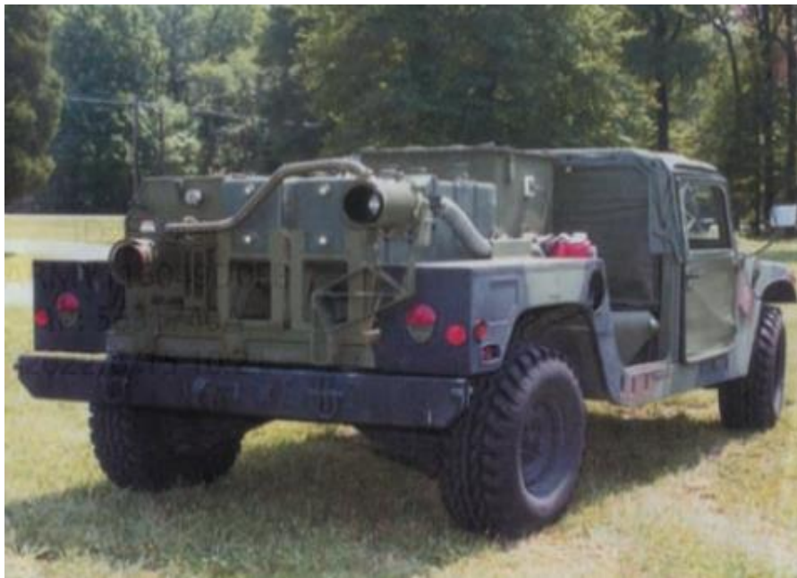
圖八：M56 渦輪發煙機
