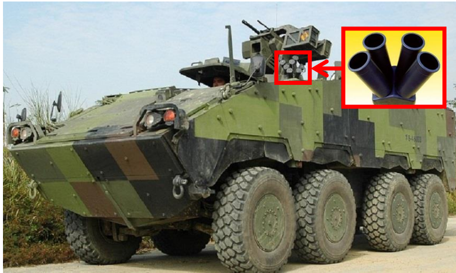
圖五：M243 煙幕發射器
