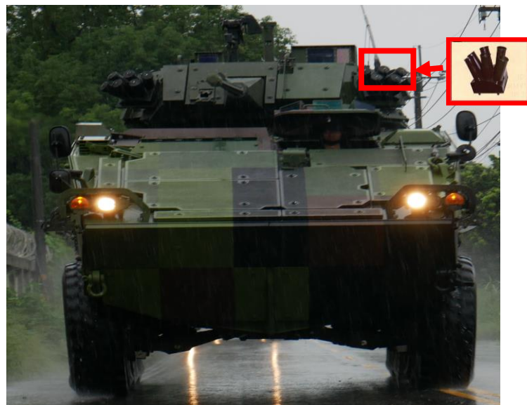
圖六：T85 煙幕發射器
