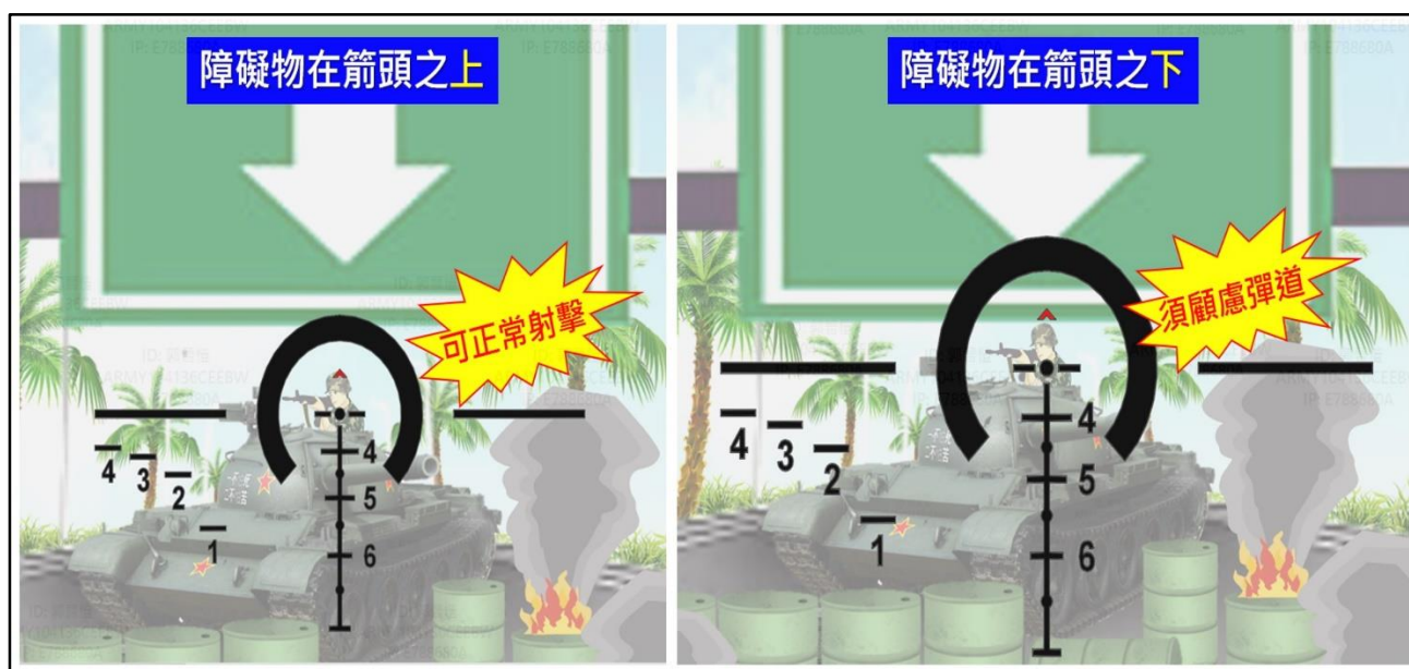
圖十五 國造 TS112 近戰瞄準鏡—彈道遮障射擊可行性判定示意圖 資料來源：作者自行調製（2024 年 9 月 13 日）
