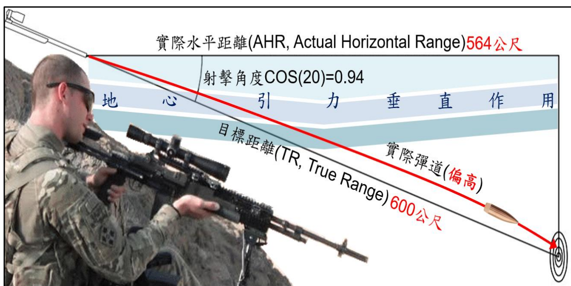
圖四 角度射擊彈道影響示意圖
