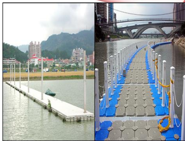
圖5 臨時浮動平台、走道示意圖(二重溪鐵人活動臨時搭設平台、走道)
