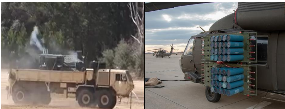
圖 2 火山布雷系統車載及空中布雷示意圖
