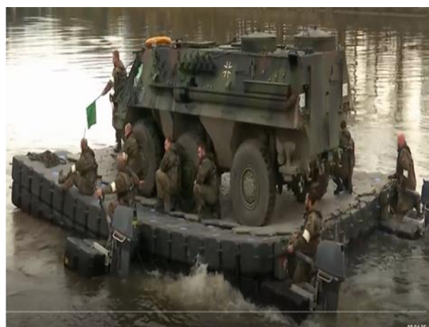
圖8 德國狐式輪型甲車運用浮動平(載)台圖(狐式輪型甲車長6.83M、寬2.98M、重21噸)
