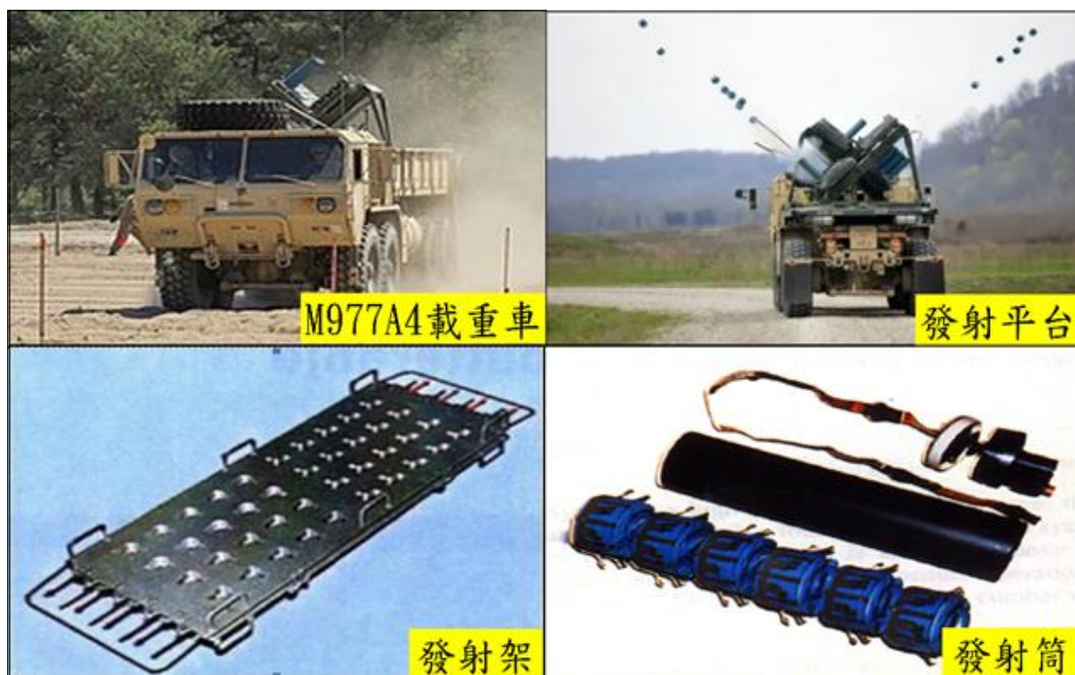
圖1 火山布雷系統組成示意圖
