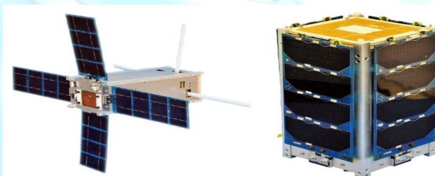
圖 9 堅果衛星太陽能板與天線的展開及閉合狀態示意圖
