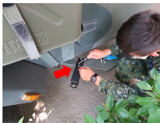
圖 25 安裝新型雷射標示器 LPU
