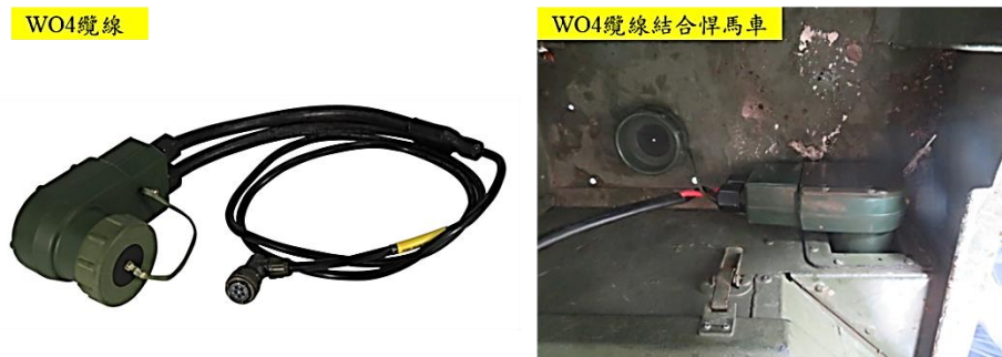
圖 6 WO4 纜線與纜線結合悍馬車示意
