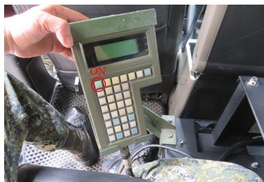
圖 27 完成定位定向系統開機
