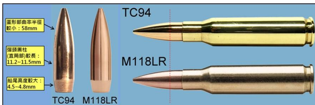
圖十 國造 TC94 與美造 M118LR 狙擊彈彈形差異比較
