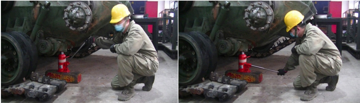
圖三 液壓千斤頂操作
