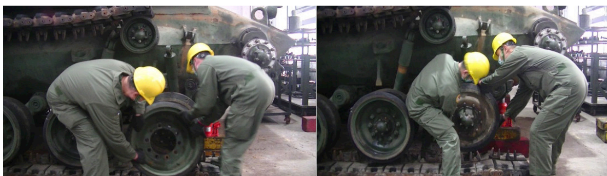
圖五 承載輪拆裝作業
