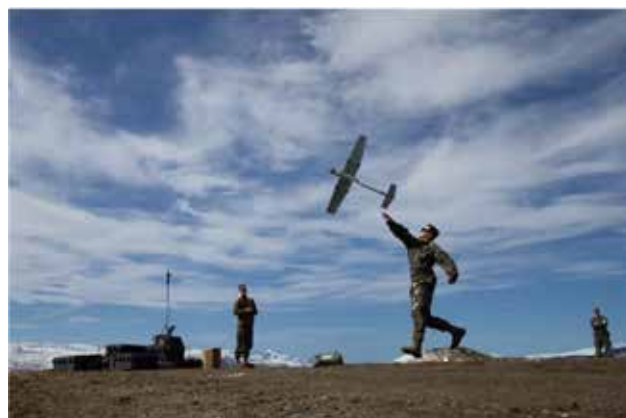
圖3 小型無人機以投射、彈射等簡便方式起飛，適合前線部隊即時運用。
